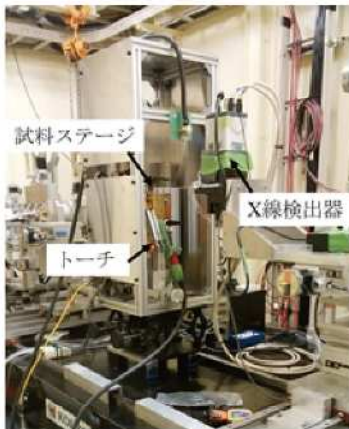
図1 SPring-8の20XUハッチ内に設置されたその場観察用のTIG溶接装置 [6-8]
