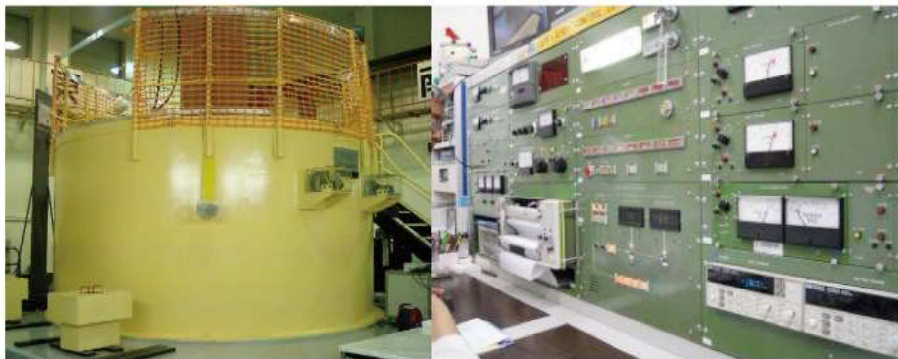
図4 近畿大学の教育用原子炉 左：原子炉本体 右：原子炉制御盤
