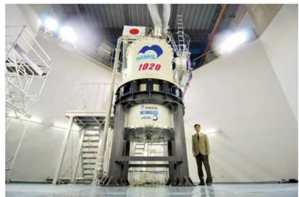
図4. 1.02GHz-NMRマグネット外観(出所:NIMS)
