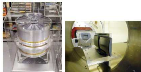
図3: XL-Calibur 用硬 X 線望遠鏡 (左) と、FORCE 用 X 線望遠鏡モジュール (右)
