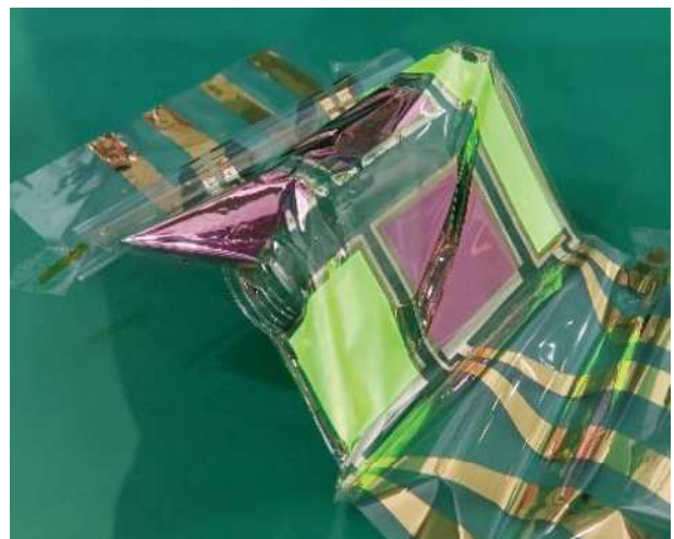
図9 総膜厚3 μmの有機EL素子
