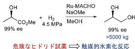
式1 Ru-MACHOを用いたエステルの触媒的水素化反応
