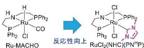
式2 常圧水素圧下におけるエステルの水素化反応
