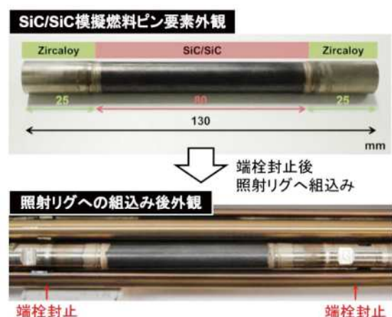
図 1 ハルデン原子炉照射用の SiC/SiC 模擬燃料ピン要素の外観
