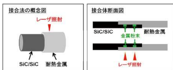
図2 本異材接合技術の概念図
