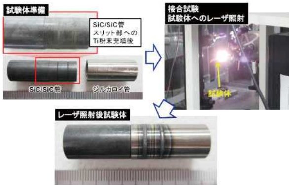
図4 レーザ局所過熱による SiC/SiC 複合材料—ジルカロイ異材接合体の作製
