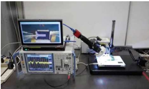
図3 開発した電磁波解析攻撃センサの実験セットアップ
