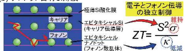
図 3 ナノドットを用いた熱電変換性能向上 2),3) . Reprinted from Nakamura et al., 2), Copyright (2015), with permission from Elsevier.
