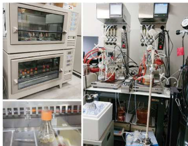
図 1 CHO 及び CHL-YN 細胞の浮遊培養 (写真左はプラスチック培養、右はリアクター培養)
