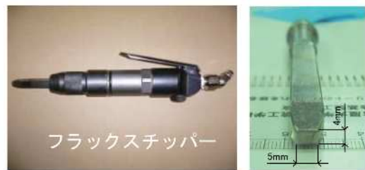
図2 衝撃き裂閉口処理に用いるエアーツール
