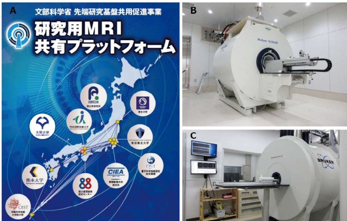
図1 研究用MRI共有プラットフォームと前臨床MRI画像 A. 研究用MRI共有プラットフォームポスター B. 前臨床用7T-MRI(30cmボア, 国立循環器病研究センター) C. 前臨床用7T-MRI(16cmボア, 大阪大学保健学専攻)
