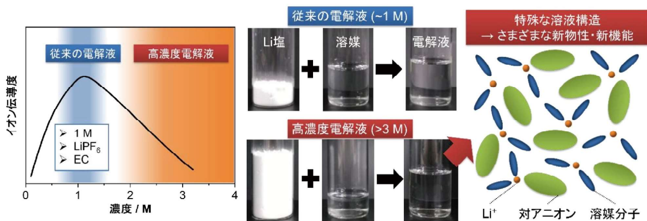
図1 ある有機溶液のリチウム塩濃度とイオン伝導度の関係。高濃度化するとイオン伝導度は低下するが、特殊な溶液構造（イオン・溶媒分子の配位状態）に基づくさまざまな新物性・新機能が現れるため、次世代電解液材料として注目されている。
