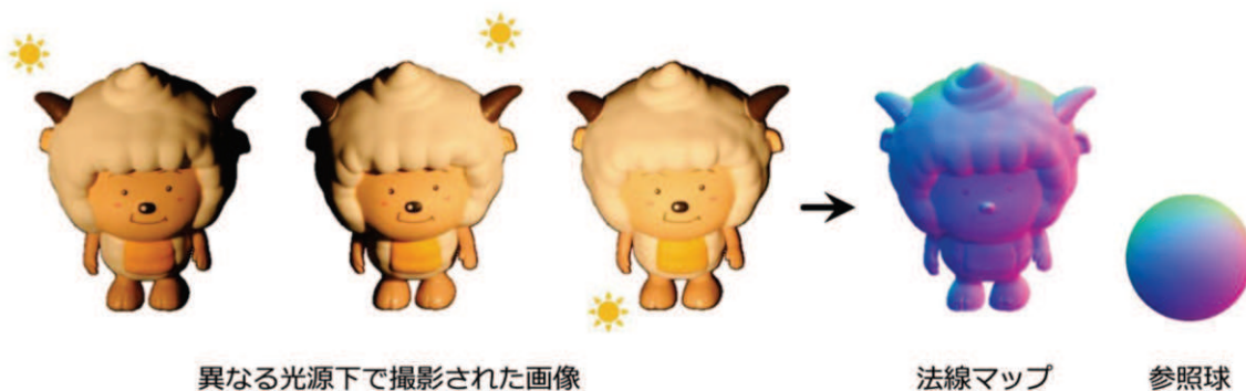
図2 照度差ステレオ法による法線マップの推定（参照球は法線と色との関係を示す）
