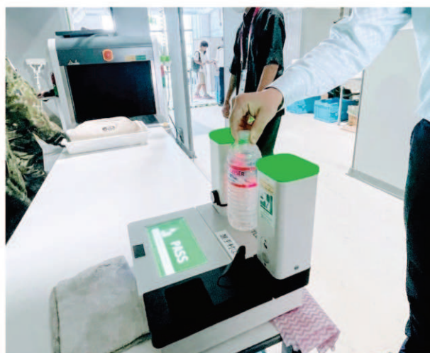
図2 東京晴海の選手村（2021年開催の国際大会）の警備で運用中の液体検査装置（株）熊平製作所製
