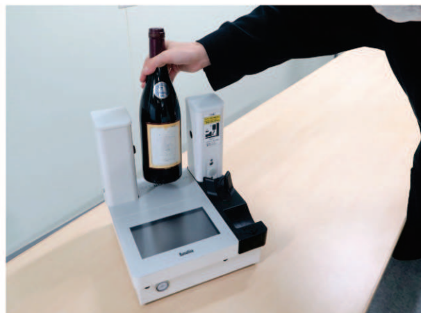
図1 空港手荷物検査用液体検査装置 (株)熊平製作所製
