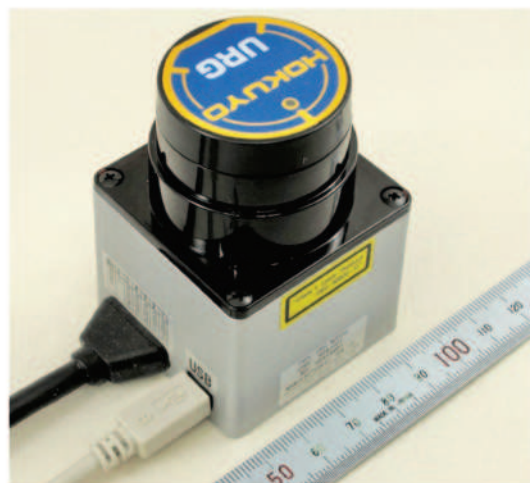
図 2. 世界で初めて市販されたサービスロボット用測域センサ URG-04LX の概観
