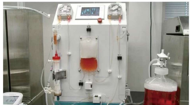
図2 中空糸膜を用いた10L規模培養の培地交換操作
