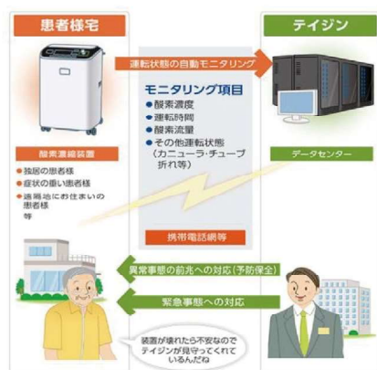
図 4-2 酸素濃縮器モニタリングシステム「HOT 見守り番 (R)」(当社 HP より)
