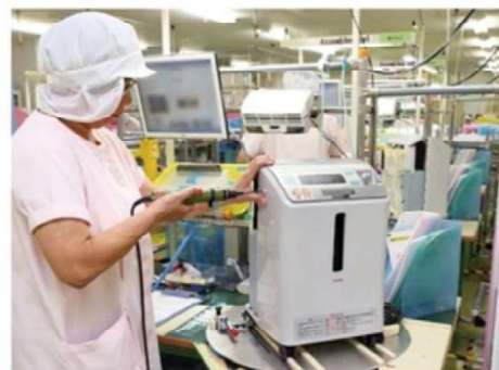
図 4-4 自社工場における酸素濃縮器のメンテナンス作業 (当社 HP より)
