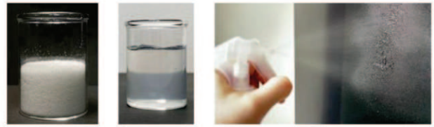
図 4 凍結乾燥で作製した CNF パウダーの外観 (左) このパウダーを水に加えて再分散すると無色透明な液体になり (中)、霧吹きしても液だれしない (右)
