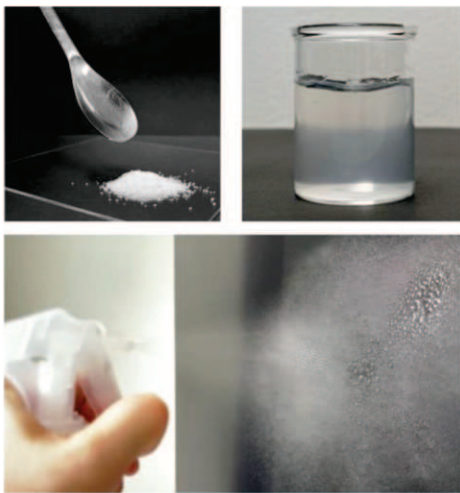
図 1 左上：開発したコンパクトな CNF パウダー、右上：水に混ぜると無色透明な液体に、下：霧吹きしても液だれしない
