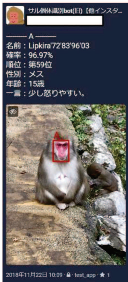
図3: 個体識別システムのスクリーンショット。スマホで撮影した画像をサーバに送信すると、画像の中からニホンサルの顔を抽出して(赤い枠)、個体識別をして、個体情報をスマホに送り返す。システムはこのサルをLipkira'72'83'96'03と推測しているが、その推測は正しかった。研究者が記録してきた個体情報を添えることで、ただのサルが、固有の人生と個性をもったかけがえのない存在に変化していくことを体験してもらいたい。
