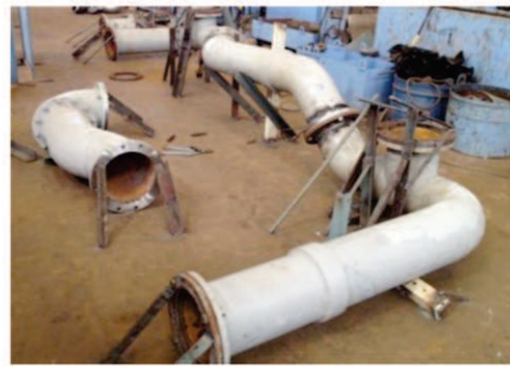
図3 配管の定盤での型取り作業 (従来法)
