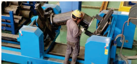
図 6 パイプ再現装置による配管型取り作業
