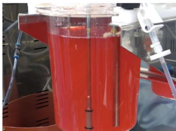
図4. iPS細胞から心筋細胞を大量製造する装置
