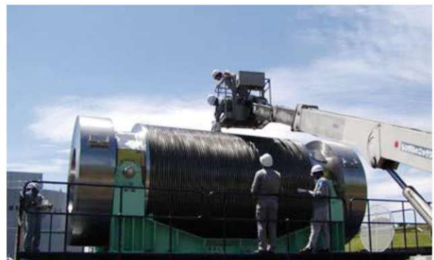
図2 放射線測定中の輸送キャスク
