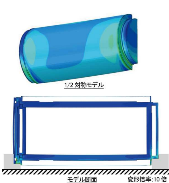
図 5 9m 水平落下における解析例
