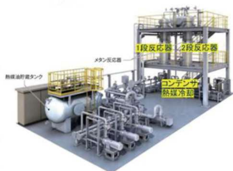
図8 メタネーション実証設備 9)
