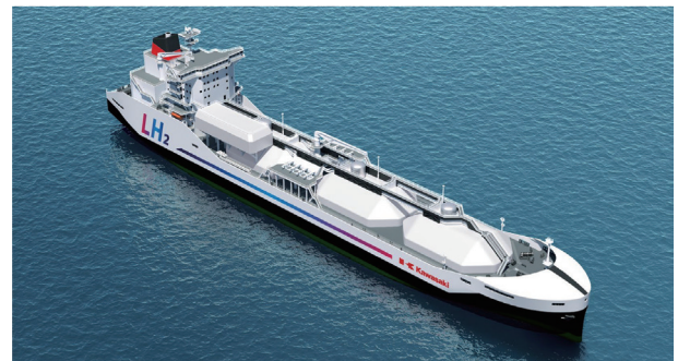
図4 4万m 3 型液化水素運搬船(イメージ) (川崎重工業より提供)
