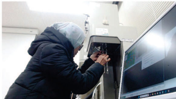
写真2. 比表面積測定実習の様子。サンプルをセット後、宿舎から装置をリモート制御して測定を進めた。
